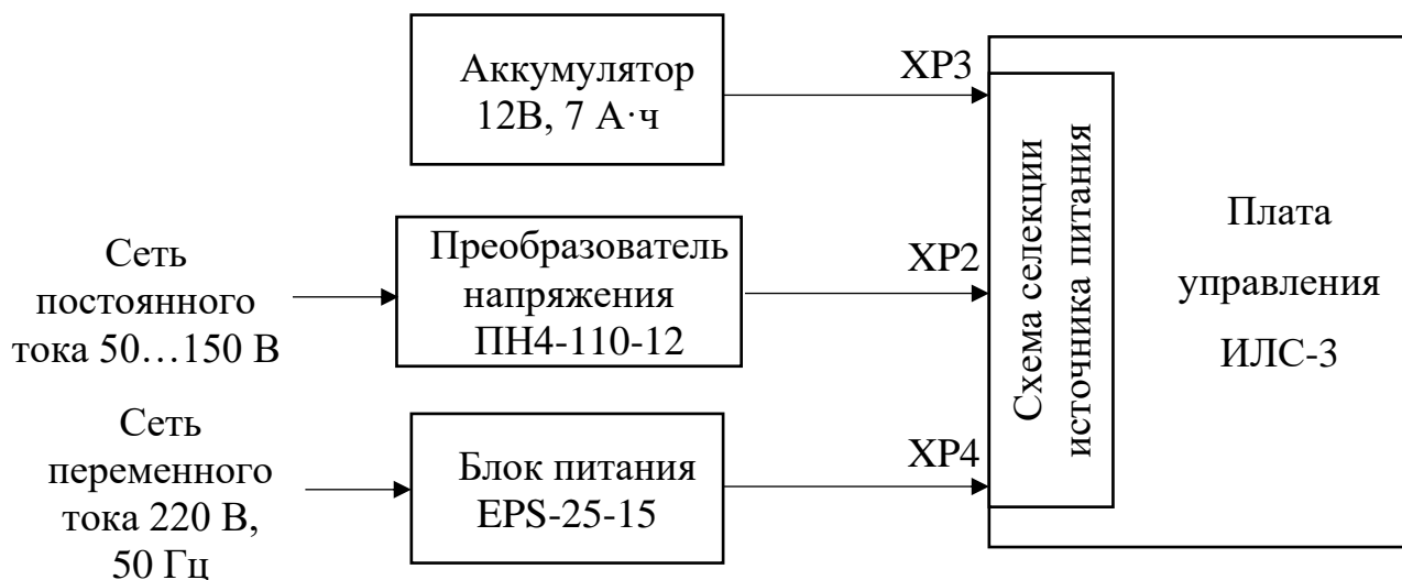
Рисунок 3 — Блок-схема питания платы управления ИЛС-3
